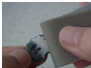
水でしっかり洗って浸み込んだイブシ液を落とし、スポンジ研磨剤の青→緑、又は紙やすり # 600→# 1200 で表面の黒い部分を落とした後、さらに磨いて光らせる。
