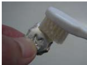
イブシ仕上げの時は全体が均一に燻せるように、湿らせた歯ブラシに重曹を付けて作品を磨き、油分を落として水洗いする。
