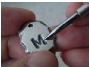
磨きヘラで平らな部分と縁を強く擦る様に磨いて更に光らせる。
