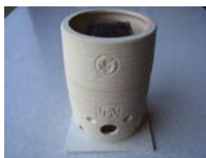
2. 網をのせてヤスリで整えた作品を置き、フタと網のハットをかぶせる。(ハットはシルバーポットに付属している網の名称)
