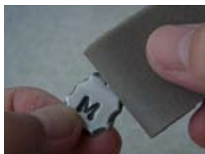
水でしっかり洗って浸み込んだイブシ液を落とし、スポンジ研磨剤の青→緑、又は紙やすり # 600→# 1200 で表面の黒い部分を落とした後、さらに磨いて光らせる。
