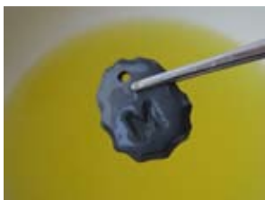
水でしっかり洗って浸み込んだイブシ液を落とし、スポンジ研磨剤の青→緑、又は紙やすり # 600→# 1200 で表面の黒い部分を落とした後、さらに磨いて光らせる。
