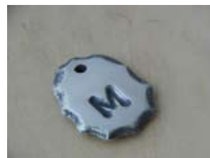
水でしっかり洗って浸み込んだイブシ液を落とし、スポンジ研磨剤の青→緑、又は紙やすり # 600→# 1200 で表面の黒い部分を落とした後、さらに磨いて光らせる。
